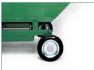
Große bruchsichere Achsräder mit verschraubter Stahlblechfelge Rad-Ø 250 mm, Radbreite 60 mm und Kugellagern 6005 ZV, für Achse Ø 25 mm, bei 600-Liter-Wagen mit Elastik-Reifen.
