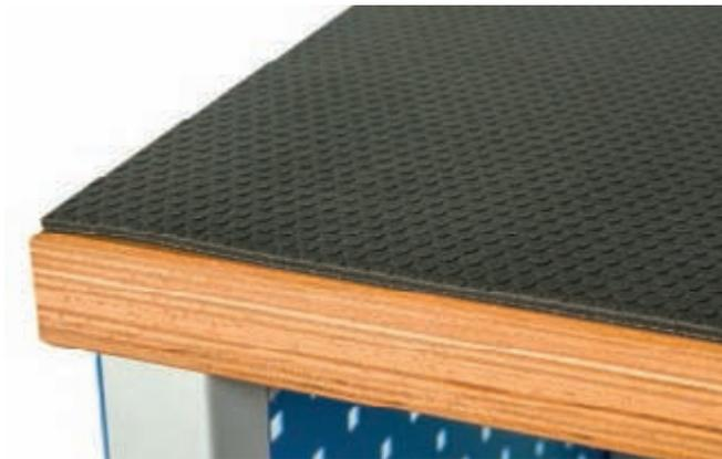
Hochbelastbare Antirutschmatte zum Einsatz als Plattenabdeckung, Transportsicherung und Bodenbelag, bestehend aus extrem hochreißfestem PES-Trägergewirke mit PVC-Weichschaum-Spezial-Beschichtung. Die Antirutschmatte „Panther“ wird gefertigt nach den neuesten EU-Verordnungen „Verbotsliste gefährlicher Stoffe“ und ist frei von Azofarbstoffen, Formaldehyd, Silikon und giftigen Schwermetallen wie Blei und Cadmium.
