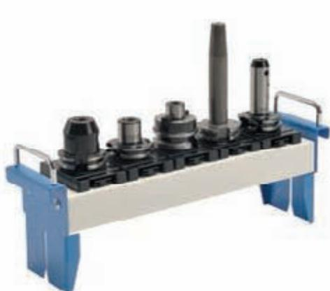
**CNC-Werkzeugaufnahmeträger (WAT), 500
