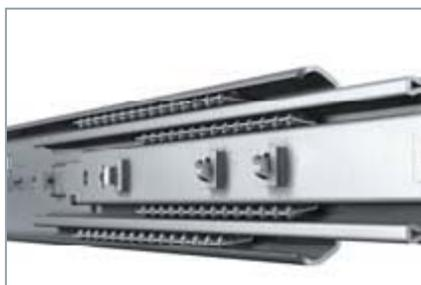
Schubladenführung, kugelgelagert, 100% ausziehbar, Schubladen mit 50 mm Blendenhöhe, 70 kg Tragkraft, Schubladen ab 75 mm Blendenhöhe 100 kg oder 180 kg Tragkraft
