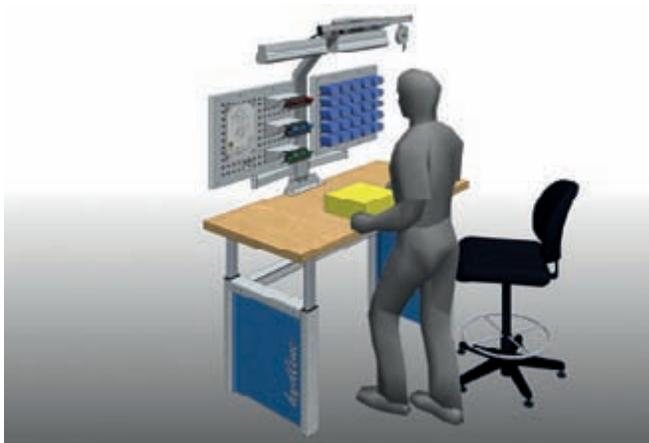
Stehend arbeiten, kleines Werkstück und große Arbeitshöhe
