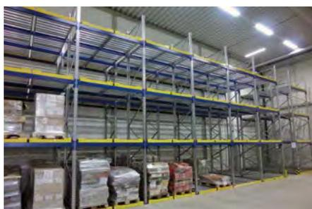
**Schwerkraftrollenbahnen** – Einsatz auf der Bodenebene und in den Fachebenen
