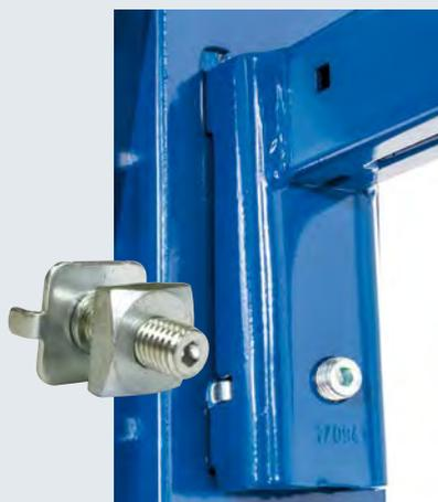
► Durch Anziehen der **Stellschraube** wird eine gleichmäßige Vorneigung erreicht. Rundmaterial rollt so automatisch Richtung Ständer. Gleichzeitig wird eine feste Verbindung zwischen Kragarm und Ständerprofil hergestellt.
