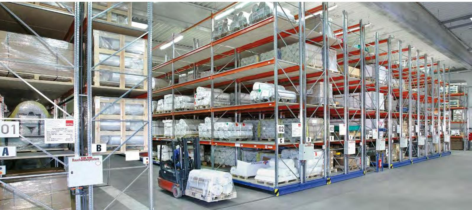
**META MULTIBLOC verfahrbare Regale** sind in der Variante mit **elektromotorischem Antrieb** mit Palettenregalaufbauten (META MULTIPAL) und Kragarmregalaufbauten (META MULTISTRONG) erhältlich. Eine nachträgliche Integration und die Verwendung von vorhandenen stationären META Regalen ist realisierbar.
